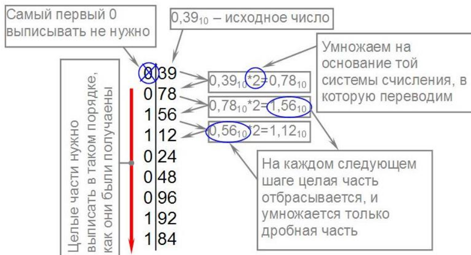
Рисунок 3. Пример перевода дробной части десятичного числа в двоичную систему счисления
