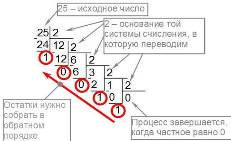
Рисунок 2. Пример перевода целого десятичного числа в двоичную систему счисления
